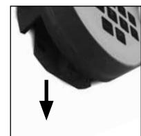
Entfernen Sie die alten Batterien und entsorgen Sie sie gemäß der Entsorgungshinweise auf Seite 8. Ersetzen Sie die Batterien durch vier neue 1,5 V AA Mignon-Batterien und gemäß der korrekten Polung. Hierzu sind Abbildungen auf der Batteriehalterung dargestellt. Bitte benutzen Sie Markenbatterien und keine Akkus.
