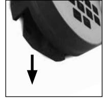
Verwijder de verbruikte batterijen en voer deze af volgens de afvoerinstucties op pagina 29. Vervang de batterijen door vier nieuwe 1,5 V AA Mignon-batterijen en let op de juiste polariteit. Hier voor zijn afbeeldingen op de batterijhouder te zien. Gebruik a.u.b. merkbatterijen en geen oplaadbare batterijen.
